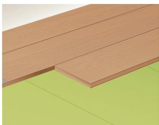
Installieren Sie Green Silence im kompletten Raum auf diese Art und Weise und verlegen Sie den Fußboden mit seiner langen Seite im 90° Winkel zu den Stößen der Dämmunterlage, direkt über Green Silence.
