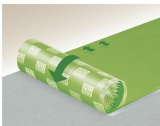
Planen Sie die Verlegerichtung ihres Fußbodens und installieren Sie die Green Silence Bahnen im 90° Winkel zur langen Seite der Planken. Die Papierseite zeigt dabei nach oben und die Dampfbremse gegen den Rohfußboden. Legen Sie Green Silence am äußeren Rand des Installationsraums an und rollen Sie es so aus, dass ein direkter Kontakt mit dem Unterboden entsteht.
